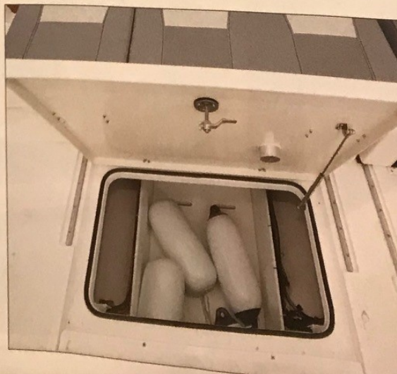
Le revêtement en teck empêche hélas d'ouvrir davantage le capot de la baille à mouillage.
